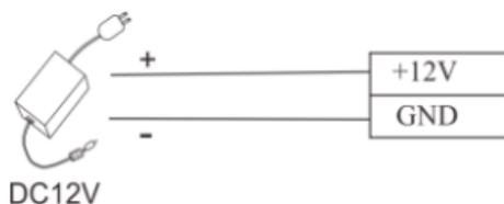
本设备的工作电源为 DC12V，工作电流为 500mA，待机电流为 50mA，将电源的正负极连接在+12V 和 GND 之间即可工作(请勿将正负极接反)。
