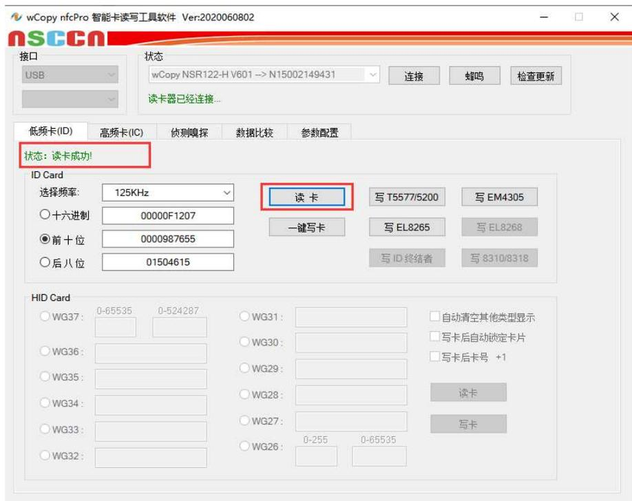
读卡成功后取下原卡，换上 ID 复制空卡，点击一键写卡或者选择相对应的复制卡型号写卡按钮进行写卡，写卡成功后软件提示写卡成功。如已知卡号也可在软件上手动输入十六进制、前十位或者后八位卡号进行写卡，写卡成功即复制完成。
