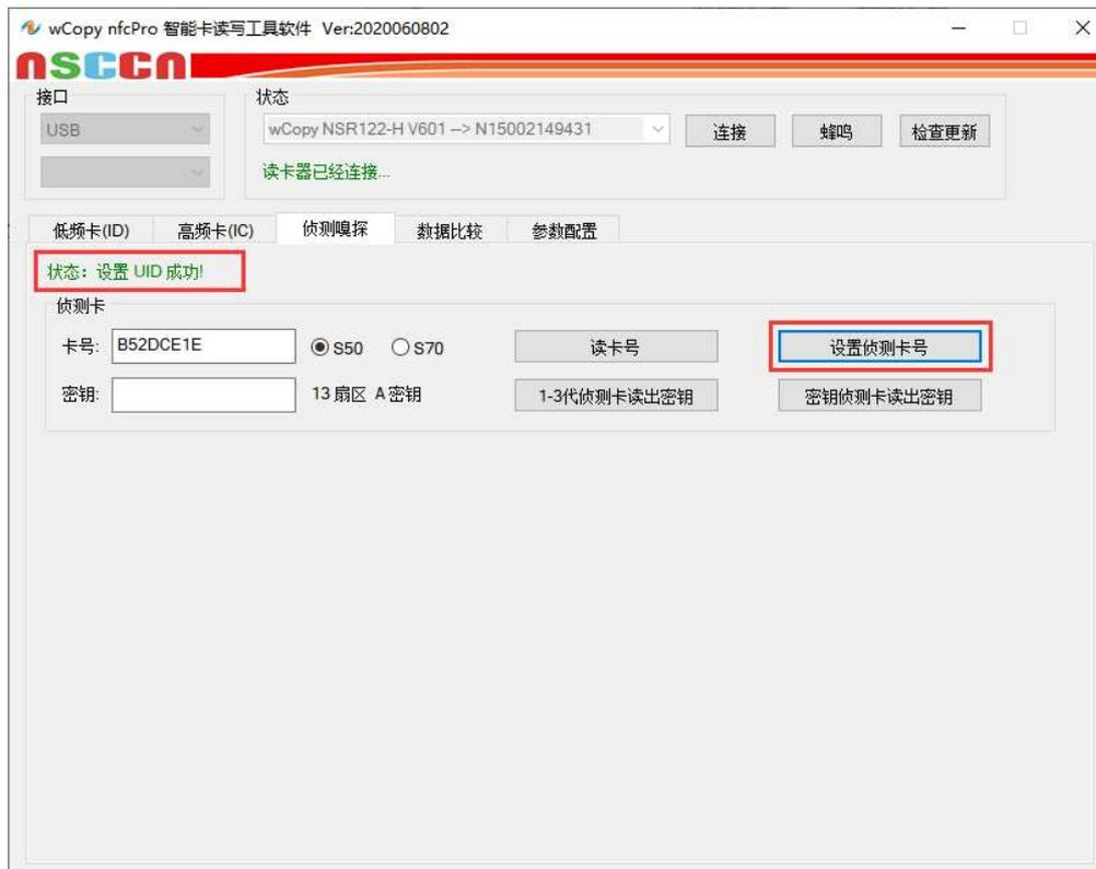
设置成功后，把原卡跟 1-3 代侦测卡（**具体卡类型可咨询侦测卡卖家**）拿到门禁读卡器上同时刷卡（需连续有效刷三次以上）刷卡完成后，把侦测卡放置机器感应区域，回到软件点击“1-3 代侦测卡读出密钥”，读出成功后软件提示读 KEY 成功，如不是 1-3 代侦测卡（**具体卡类型可咨询侦测卡卖家**），可点击“密钥侦测卡读出密钥”（如图所示）
