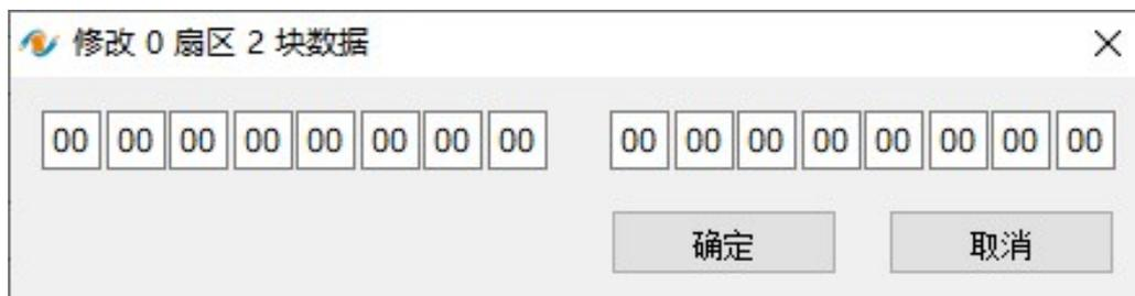
可根据需求填写区块数据（方框里的 00），填写完成后点击确定，把复制空卡放置机器的读卡区域，再单击选中之前修改的区块数据，点击“写单块数据”按钮进行写卡，机器“滴”一声，软件提示“写卡片单一数据块成功”。或点击“另存数据”按钮，保存修改过的 dump 文件。如图所示：
