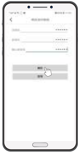
3. 输入6位旧密码（初始密码默认为123456）然后输入6位新密码，再次输入6位新密码确认，点击确认，完成设备密码修改，提示修改密码成功
